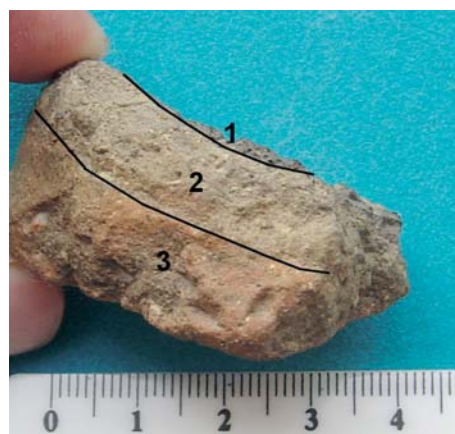
Fig. 4 Perfil lateral do fundo cerâmico (1 - escória negra; 2 - pasta cinzento-esverdeada (fractura no arranque da parede do vaso); 3 - exterior do fundo de cor castanha-avermelhada).
