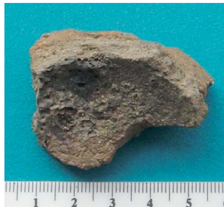
Fig. 2 Superfície interna do fundo de vaso cerâmico com escória aderente. Note-se a superfície irregular desta, com algumas vesículas semi-destruídas, e a ausência de escória na zona mais central do fundo.
