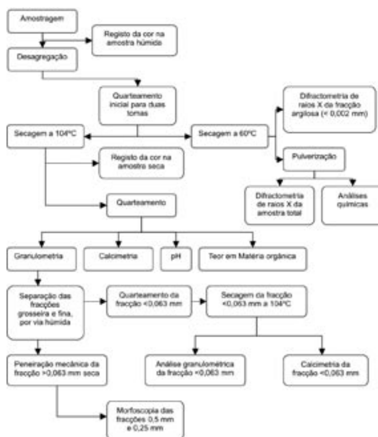
Fig. 5 Fluxograma sumário dos processos laboratoriais realizados para a caracterização físico-química dos solos.
