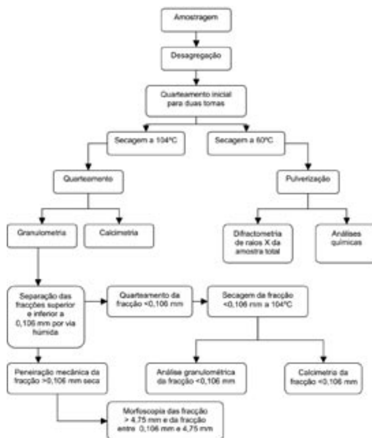
Fig. 6 Fluxograma sumário dos processos laboratoriais realizados para a caracterização da matéria-prima constituinte das estruturas arqueológicas da Idade do Bronze.
